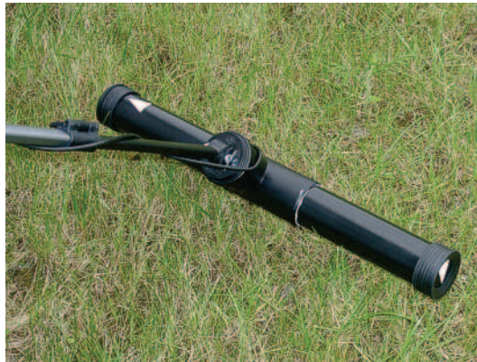
الرسم 7.16: المسح المباشر: توجيه محس البث المباشر
