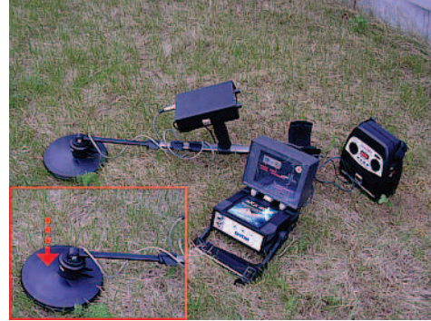
الرسم 9.3: معايرة نظام الـ DDV، الخطوة الأولى
