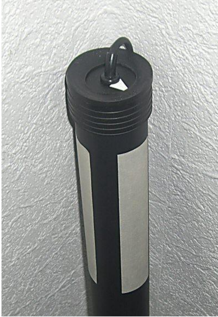
Şekil 9.2: Taramada Süper Sensör yardımına ilave işaret ekleme
