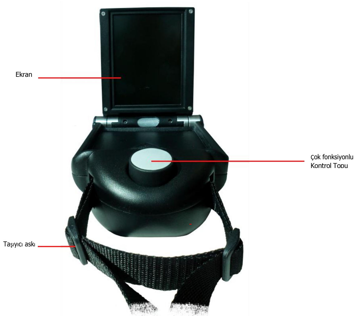
Şekil 6.2: Kontrol ünitesinin önden görünümü
