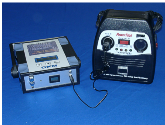
Abbildung 5: Anschluß der externen Stromversorgung (Optional)
