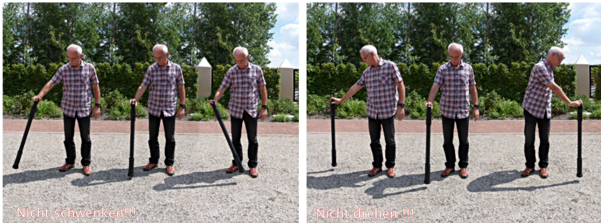
Abbildung 7.6: Das Schwenken oder Drehen der Sonde verfälscht die Messung.
