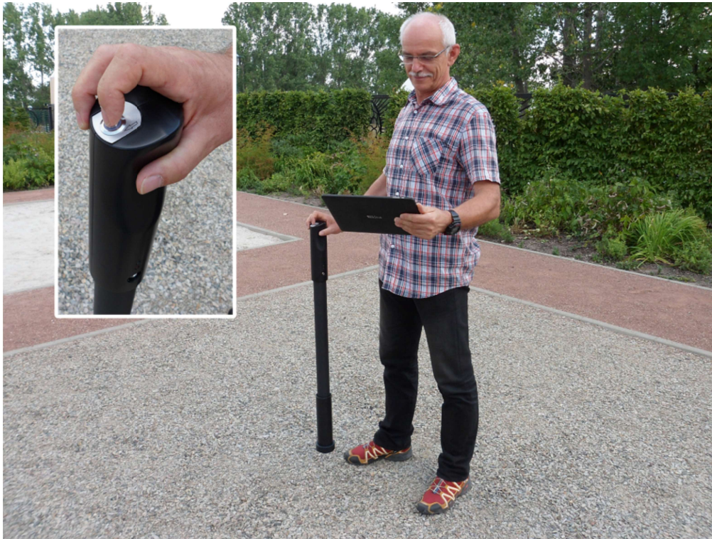
Abbildung 6.1: Nutzung des Detektors im vertikalen Modus
