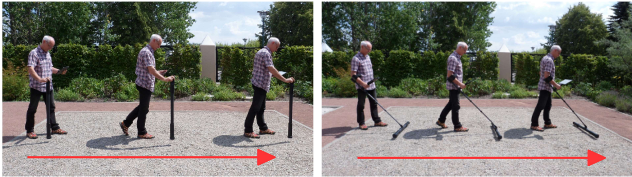
Abbildung 7.11: Ground Scan im vertikalen und horizontalen Modus
