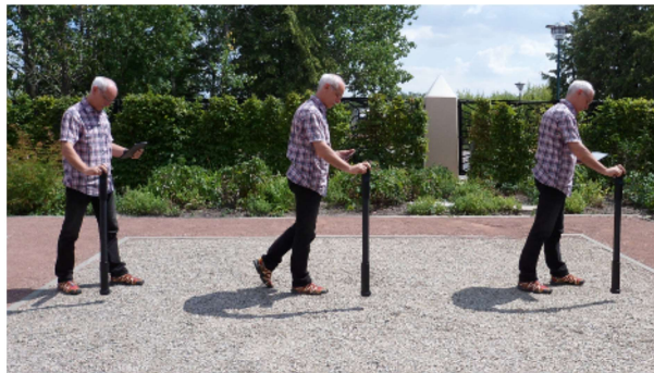
Abbildung 7.5: Die Sonde sollte immer nach unten zeigen und nicht gedreht werden
